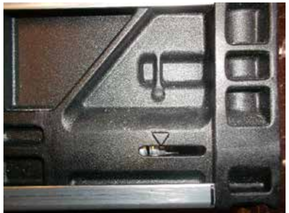
Remonter le tout. Tendre la chaîne jusqu'à l'alignement des repères.
