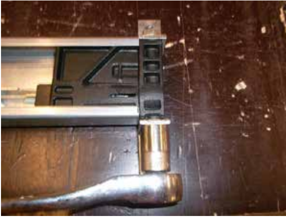
Démonter les pates de fixation du rail.
