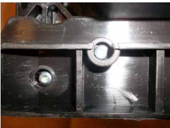
Dévisser les contacteurs (2vis sur le côté) et les remplacer. Rebrancher les nouveaux sur la carte.
